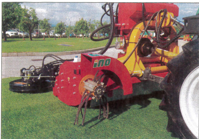
Novi pletvenik enostavno namestimo na mesto podporne nogice in priključimo na mulčer par hidravličnih cevi.
