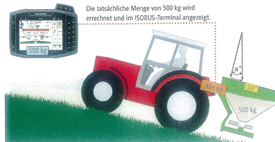
Zum Ausrichten des Streuers in die waagerechte Position wird die Neigung beim ZA-TS von Amazone im Isobus-Terminal angezeigt.
