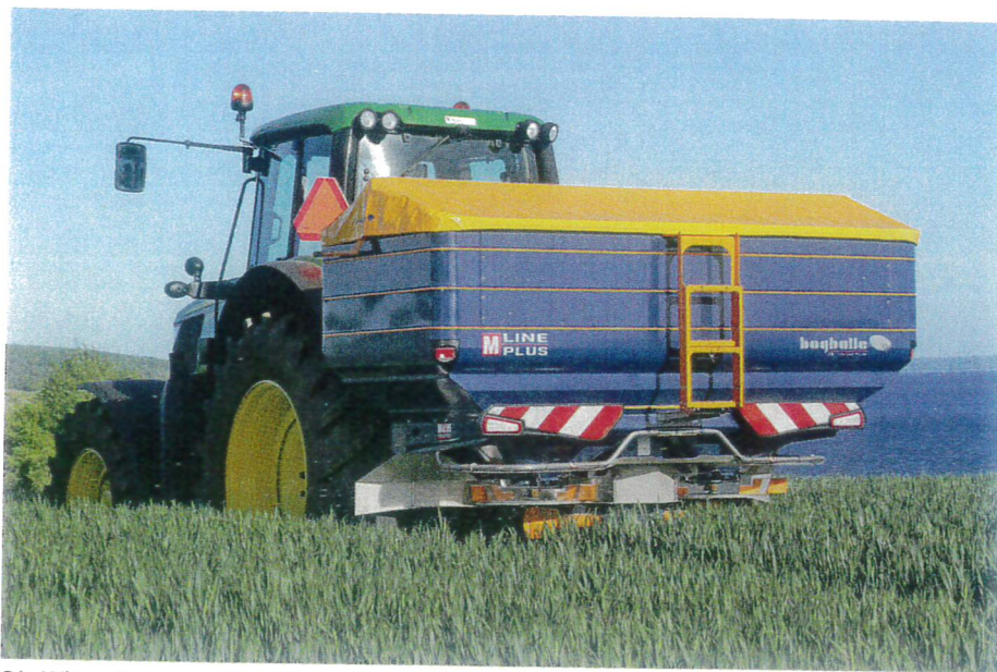
Die Wiegestreuer von Bogballe verfügen über eine integrierte Wiegeeinrichtung, die – über intelligente Neigungs- und Schwingungssensorik – eine 1:1 Online-Messung zulässt.
