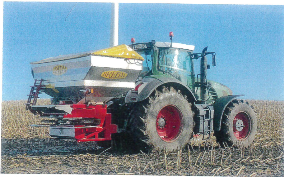
Der Anbaustreuer F4 der dänischen Firma Bredal ermöglicht abgestuftes Düngen, das Rand- und Grenzstreuen, Vorgewendestreuen sowie das Streuen in Keilflächen und Restflächen.
