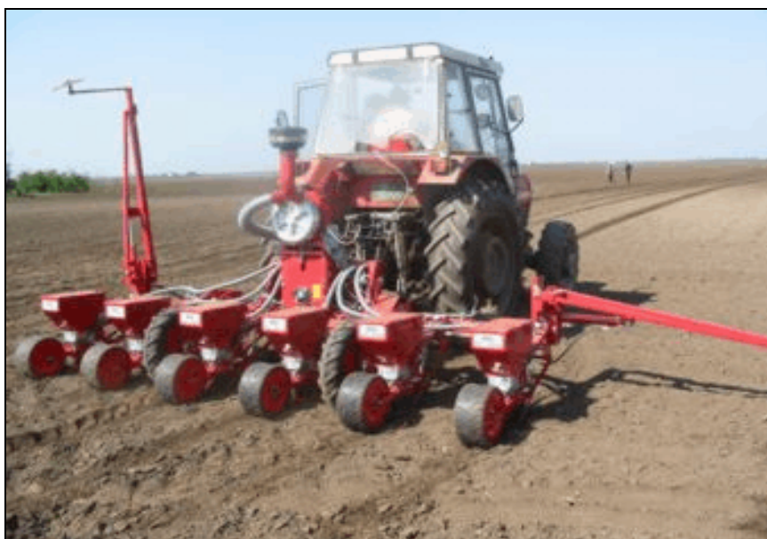
Sl. 10. Setveni agregat IMT 580 + INO Becker aeromat A u setvi
