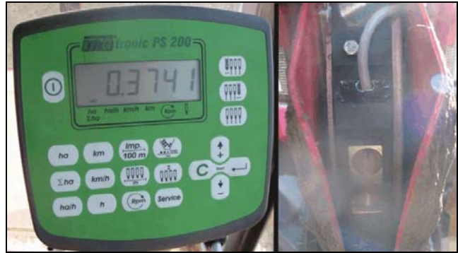
Sl. 13. Inotronic komandni uređaj i davač ulaganja semena
