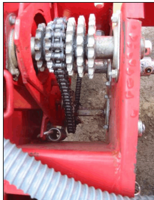
Sl. 5. Set lančanika za podešavanje prenosnog odnosa u prenosu obrtnog momenta od pogonskog točka do setvene ploče
