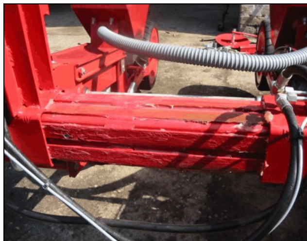
Sl. 1. Teleskopsko pomeranje krajnjih sekcija
