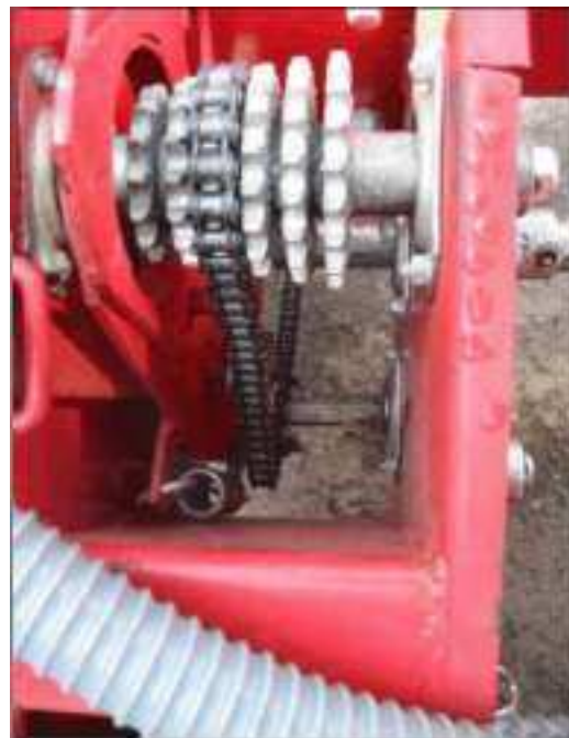
Рис. 5. коробка передач привода высевающих секций.
