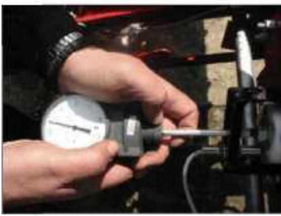
Рис. 2. Проверка числа оборотов ВОМ
