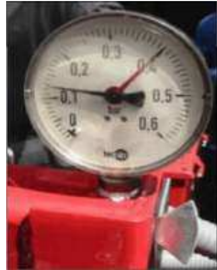
Рис. 3. Правильно установленное давление пневмо системы
