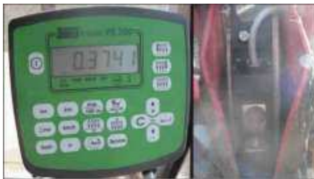
Рис. 13. Inotronic система электронного надзора сева.
