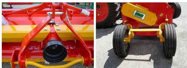
Tritočkovni sistem omogoča hitro priklapljanje brez napora
